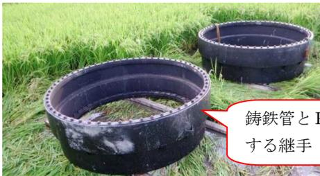
鋳鉄管とPC管を接続する継手
