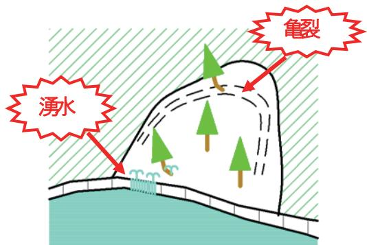
図 25: ため池法面からの湧水・亀裂
