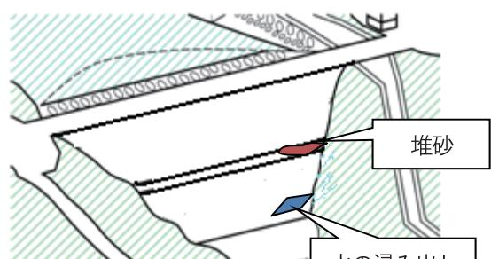
図 16：小段承水路の堆砂、堤体下流法面からの水の浸み出し
