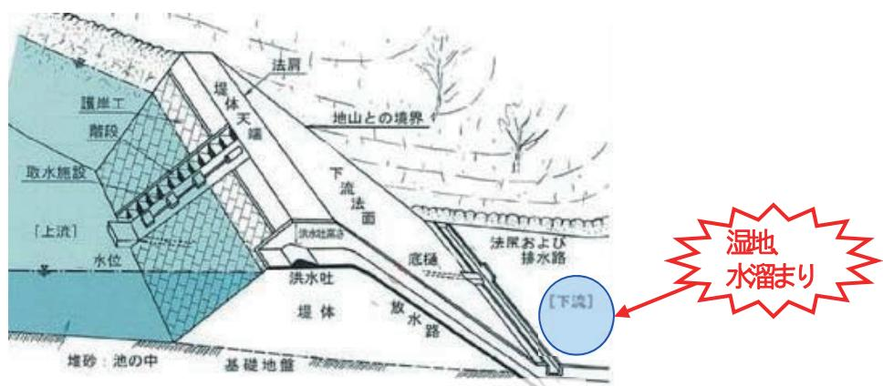
図 23：下流地盤の水溜り
