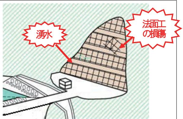
図 26: 堤体近接法面工の損傷・湧水
